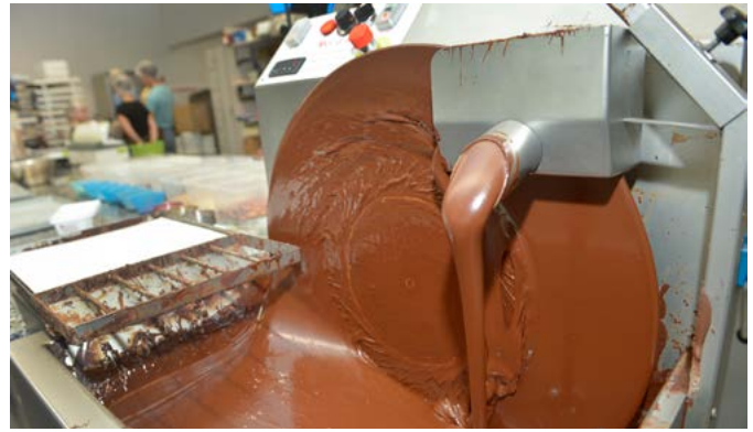
Die belgische Temperiermaschine gehört zu den vielen Gerätschaften, die für die Herstellung edler Schokolade nötig sind.
