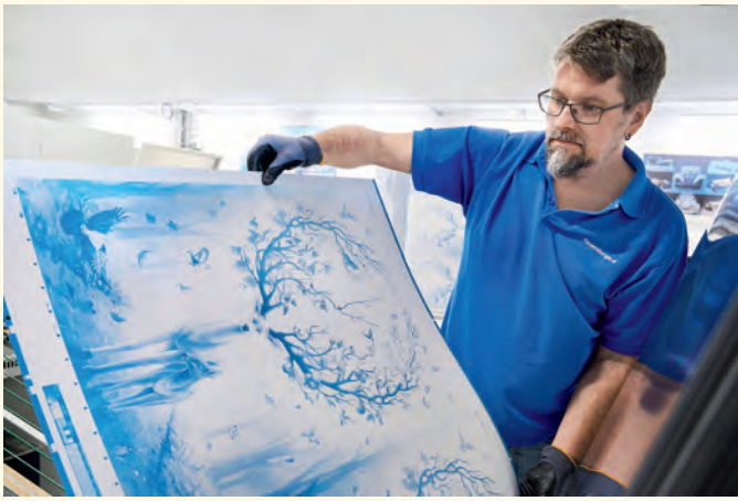
Für die Druckfarben Cyan, Magenta, Yellow und Black wird je eine eigene Druckplatte belichtet.
