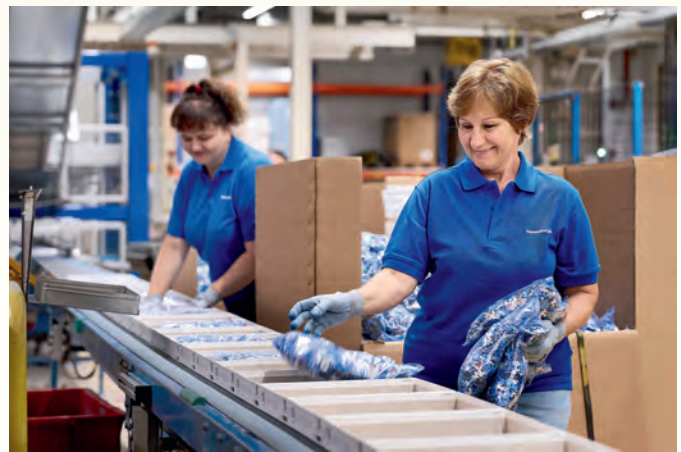
Die Puzzlebeutel werden von Hand in die Schachtel eingelegt. Das ist Teil der Qualitätskontrolle.
