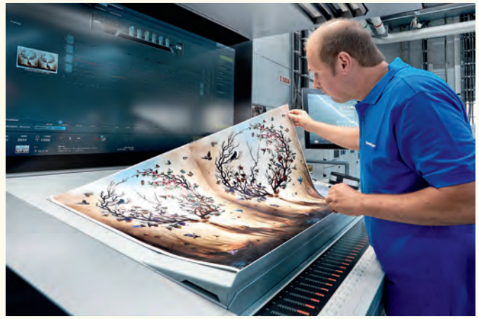
Der Mitarbeiter kontrolliert, ob das Druckergebnis optimal ist. Ist dies nicht der Fall, muss nachjustiert werden.
